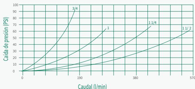
**Aplicaciones:** Estos acoples mariposa de servicio pesado están diseñados para líneas hidráulicas donde una desconexión sin pérdidas y mínima inclusión de aire son requeridos. Ideales para camiones, equipamiento petrolero y otras aplicaciones donde se necesite la posibilidad de conexión/desconexión bajo presión.
