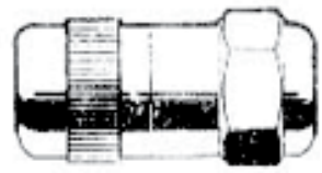
Mod. 13 Con uñas pistón y punteras de acero, cementado, superficies de contacto rectificadas, rosca hembra 1/8 gas.
