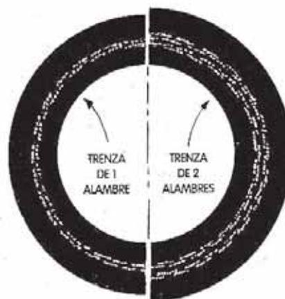
Figura 1 Vista transversal de la manguera Gates "Tipo T", con construcción de 1 y 2 alambres
