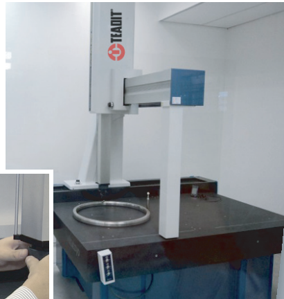
Mesa 3D para inspeção de precisão.
